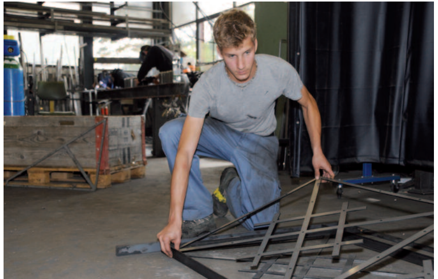
Der angehende Metallbauer Michel Gränicher baut ein Balkongeländer zusammen.
